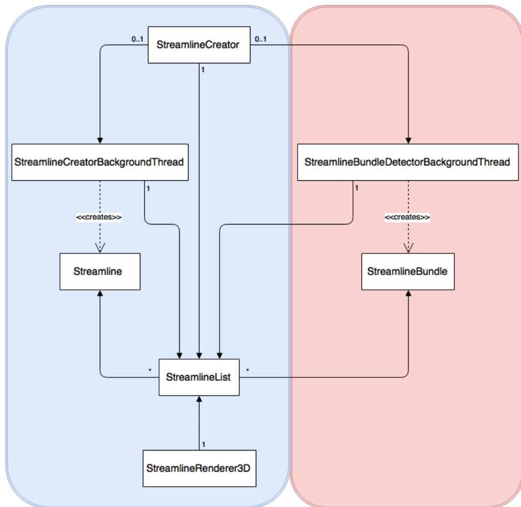
Abbildung 4.1: UML-Diagramm der wichtigsten Klassen. Der blaue Bereich beinhaltet die veränderten, der rote die hinzugefügten Klassen.
